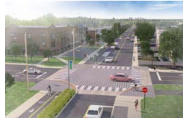
Fig. 141. Intersection surélevée (Source : Ville Sainte-Catherine).
