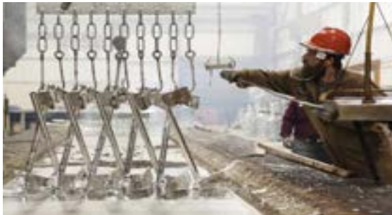
Fig. 14. Bassin de galvanisation chez Locweld (Source: Emploisit, 2019)
